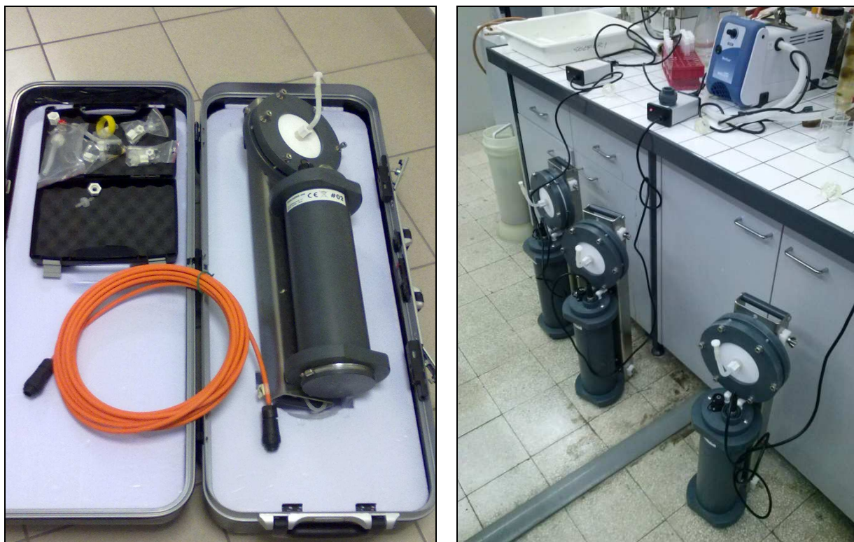
Figura 71. Dettaglio Campionatore ad Alto Volume. La pompa è controllata da un microprocessore, un misuratore di flusso, un sistema di filtrazione, una colonna di estrazione e degli accumulatori che forniscono l'energia di campionamento.
